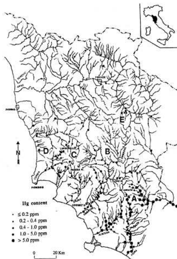
Figura 22.3. Distribuzione di Hg nei sedimenti fluviali della Toscana. Circa 1000 campioni sono stati raccolti con maglia regolare su di una superficie di circa 20.000 km 2 (Dall'Aglio ed Altri, 1966).
